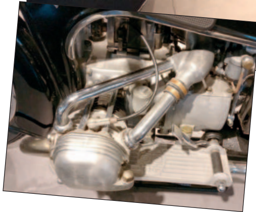
Pariisilainen 750-kuutioinen Gnome et Rhone CV2 -33. Ajokki edustaa 30-luvun mp-maailman "saksalaista koulukuntaa" prässättyne runkoineen ja varsinkin bokserimoottoreineen.
