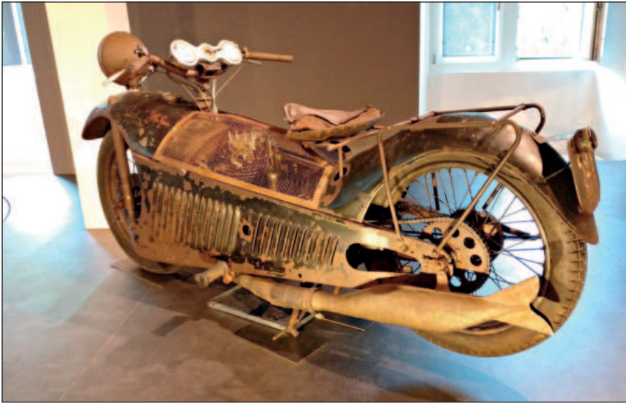
Maailman ainoa alkuperäiskunnossa säilynyt Majestic oli näytillä taannoin Neckarsulmin museon "Muotoilulliset erikoisuudet" -näyttelyssä. Malli on vuodelta 1930 ja se edustaa Majesticin viimeiseksi jäänyttä versiota. Voimalähteenä 350 cc Chaise-sivuventtiilikone. Kuva: Pauli Ylikoski
