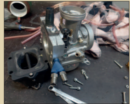
Kaasuttimen ja läppäventtiilien väliin asennettu adapteri, johon syötetään ilokaasun ja bensa seosta.
