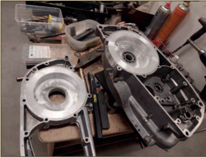
Kampikammioiden tilavuus pienennettiin alumiinikiekoilla.
