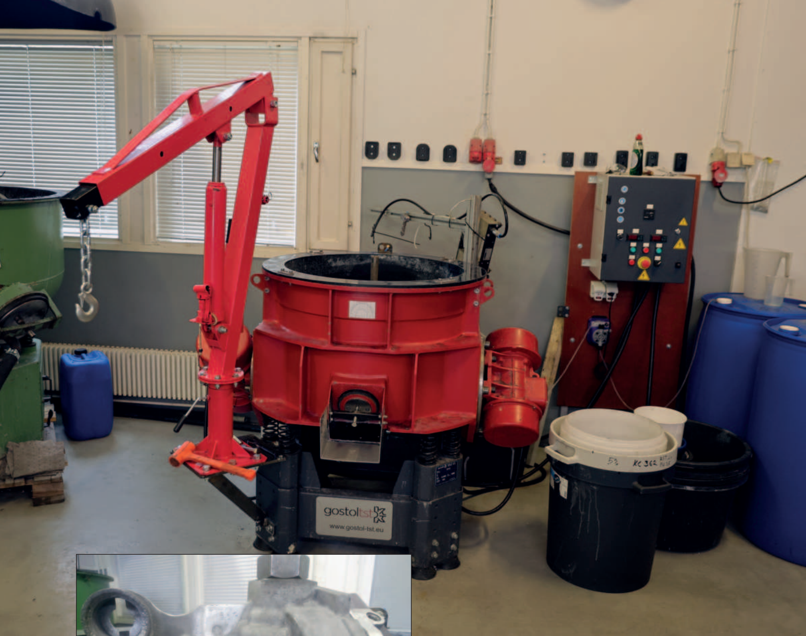
Tärykiiltoituslaitteisto kokonaisuudessaan. Vasemmalla ennen ja jälkeen - lopputulos on huikea!
