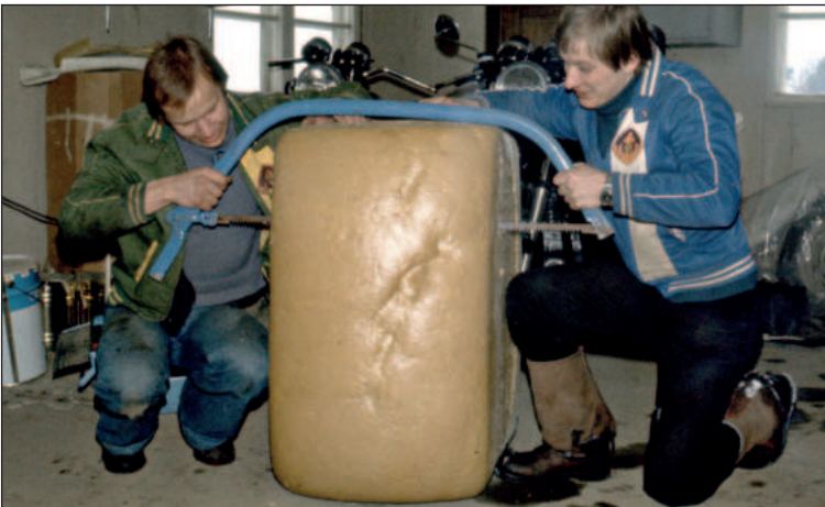
Äkkiä ei arvaisi, että tässäkin ollaan MP-harrastuksen äärellä. Kattteen uretaanimuotin muotoilua hiukan krouvimmalla työkalulla.
