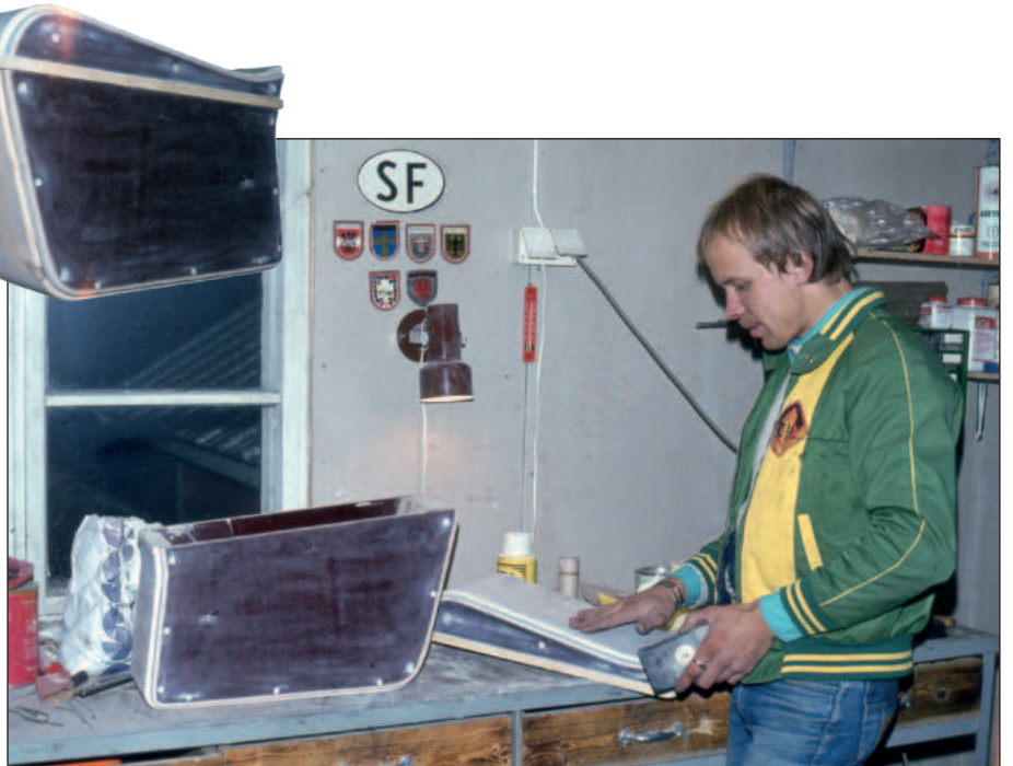
Mäkijärven Juhani ja Urkon Jorman toisessa laukkuversiossa myös muotoilu oli omaa. Alkuperäinen muotti tehtiin mäntylankuista ja vanerista. Myös tavaratelineet ja kiinnikkeet olivat itse tehtyjä. Yläkuvassa Jorma hiomassa muottia, vasemmalla Juhani sovittamassa rautoja Tuuttiin.
