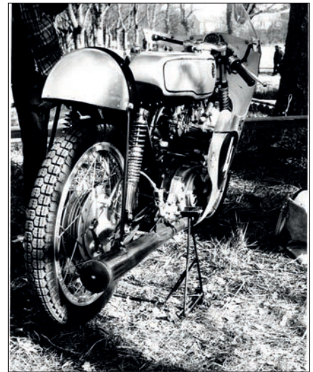
Museo Morbidellin entisöintiverstaalla Timo Vainio ja historioitsija Walter Magrini tutkivat valmistuvaa entisöintiä. Kierroslukumittarin ripustus todettiin kuuluvan -65 jälkeisiin RC-malleihin, ja etujouset ovat ylösalaisin. Kirjoittaja seuraa sivusta.
