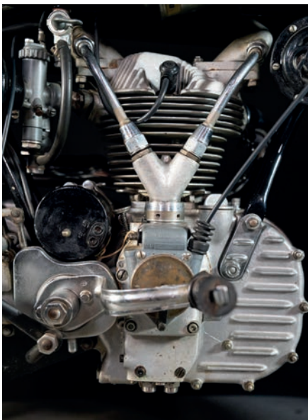
1951 NSU valmisti OSL 251 moottorin prototyypin hydraulisella venttiilinohjauksella
