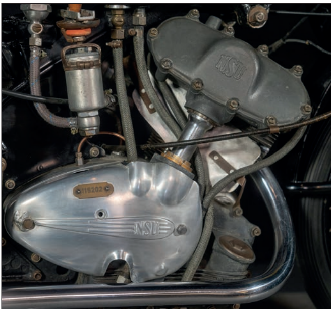
Rennfoxissa käytettiin myös magnesiumista valmistettuja osia painon pitämiseksi kurissa.
