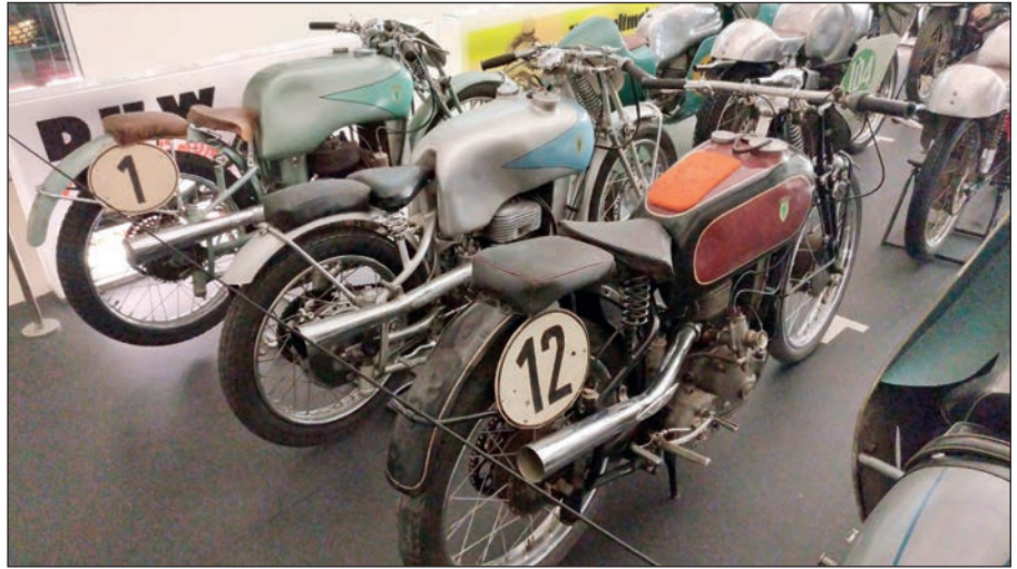
DKW-kilpureita Augustusburgin museossa: vasemmalla ULD 500 -38. U = kaksoismäntä, L = kompressor (Lader), D = pyöröluisti (Drehscieber), oikealla SS 250 -38, jollaisella Ewald Gluge otti voiton vuoden -38 Mansaaren TT:n pienimmässä luokassa peräti 11 minuutin erolla Ginger Woodiin. ( www.iomttraces.com/racing/results , kuva: Pauli Ylikoski).
