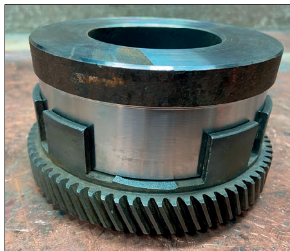
Sisäpuolen tuurna sorvattu ja asennettu paikalleen.
